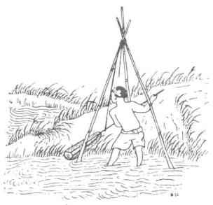
Fig. 32. - (D.) Écope à trépied. Người tát nước gầu sông.
